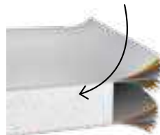
Isolierte Seitenwände/ Türelement Sandwichelement mit 40 mm Kern aus Styropor (EPS W20)
