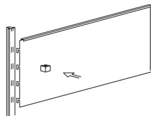
Aus Stahlblech, oben und unten zweifach abgekantet, mit seitlichen Einhängehaken und Sicherungsclips aus Kunststoff. Stabilisieren das Regal in der Länge.
