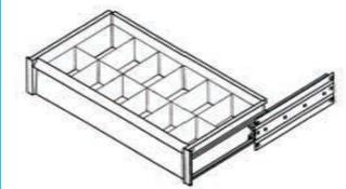
Mit dem praktischen Unterteilungssystem aus Metall können die ERREX®-Schubladen durch Schlitzwände und Trennbleche in verschieden grosse Fächer separiert werden.
