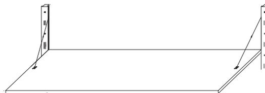
Abschliessbare, robuste Klapptüren verwandeln jedes ERREX®-Regal in einen Sekretär, eine Bar oder in ein praktisches Wohn- und Büromöbel. Die Beschläge sind mit Fallbremse ausgestattet. Klapptüren können jederzeit nachträglich montiert werden.
