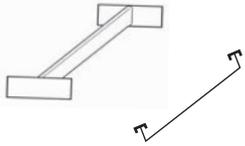
Zum Einhängen in die Ständerrahmen mittels Tablarträger, sowie in der Randfaltung der Tablare.
