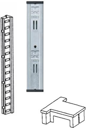
Pfeiler als lastoptimiertes abgekantetes Hohlprofil mit symmetrischer Lochstanzung. Teilung 25 mm, zum Einstecken von Trägern, Stabilisierungsplatten und Zubehör.
