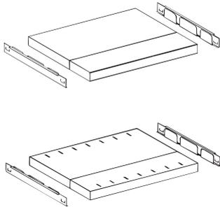
Aus Stahlblech, dreifach abgekantet, Randhöhe 30 mm. Tablartiefe: 100 und 200 mm.
