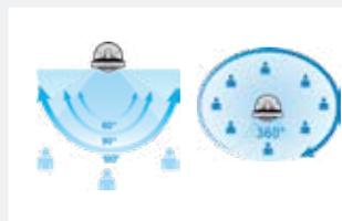
Kann um 360° rotieren oder in Winkeln von 60°, 90° und 180° oszillieren.
