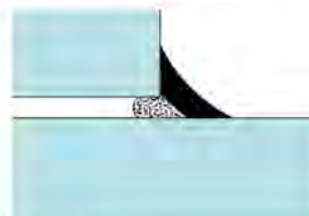
Winkelfugen Les joints d'angle
