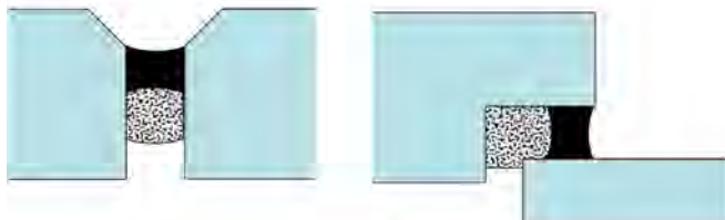
Stossfugen Les joints d'assemblage
